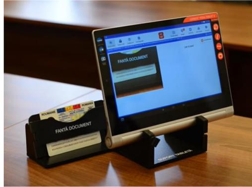
Le SIMPV repose sur une technologie permettant à une tablette informatique de scanner la pièce d'identité de l'électeur et de vérifier s'il peut voter.
